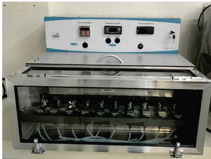
Figura 3 - Máquina de escovação (EIQuip®, São Paulo, SP), Brasil utilizada no teste de abrasão.
