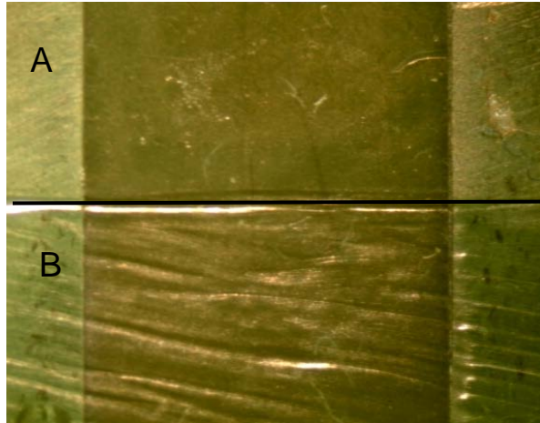
Figura 11– Fotografia de um corpo de prova do subgrupo GDT3 em lupa estereoscópica (20x) após a metalização em ouro para obtenção das eletromicrografias em MEV. (A) Face não escovada; (B) Face 24 meses após a escovação simulada.
