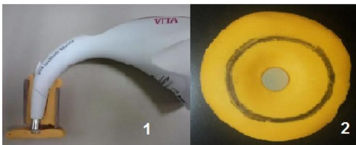
Figura 04: 1) Aparelho VITA Easyshade na matriz confeccionada para leitura de cor. 2) Posicionamento da amostra durante a leitura de cor.
