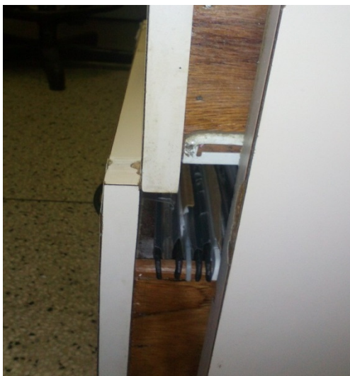
Figura 9 - Arquivos quebrados, com defeitos no deslizamento.
