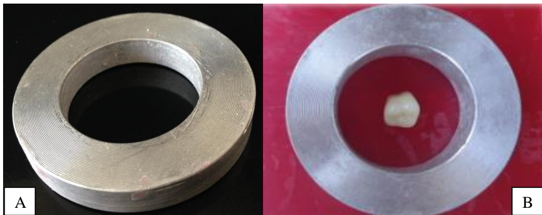
Figura 1. (A) Anel metálico utilizado para confecção dos corpos de prova. (B) Dente artificial centralizado na matriz metálica sobre a lâmina de cera e placa de vidro.
