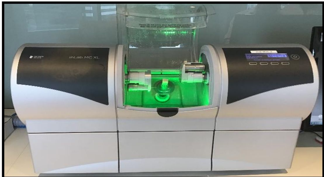
Figura 6: Unidade fresadora inLab MC XL (CEREC – Sirona - Bad Säckingen – Bensheim – Alemanha)
