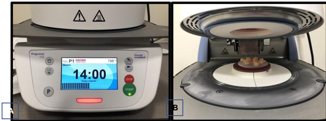
Figura 9: (A) – Forno Programat CS2; (B) – coroas na bandeja refratária após finalização do processo.
