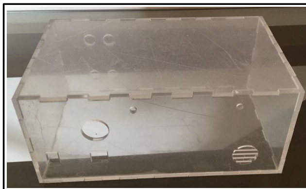
Figura 25 – Case para montagem do sistema
