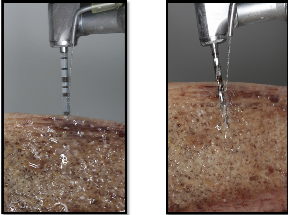
Figuras 2 e 3: Modo de utilização do preparo das brocas lança e helicoidal 2.0 mm na costela bovina simulando um osso da região anterior da mandíbula 9 .
