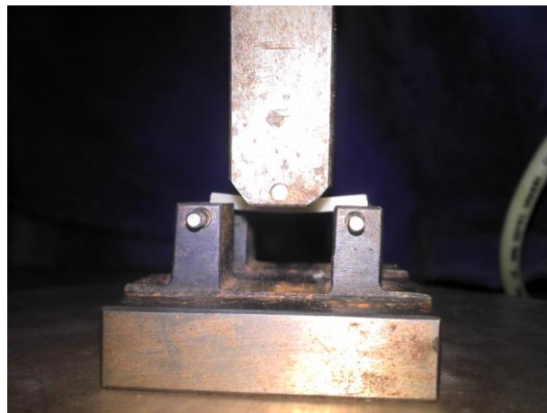
Figura 11: Ensaio de flexão através do teste de carga de três pontos com auxílio de artefato metálico.
