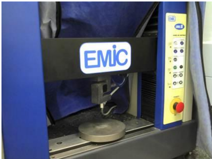
Figura 9: Máquina de ensaio universal (EMIC DL2000®).
