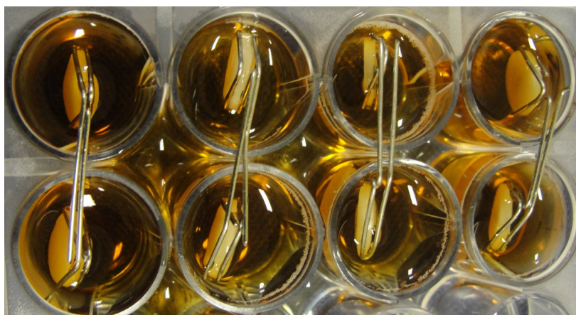
Figura 7 - Corpos de prova em suspensão bacteriana
