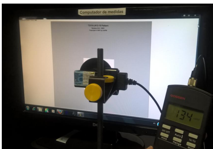
Figura 46. Ilustração do posicionamento do instrumento de medição montados com ajuda de fixador.
