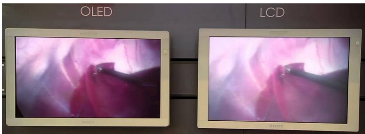
Figura 7. Comparação da qualidade da imagem de um monitor OLED vs LCD
